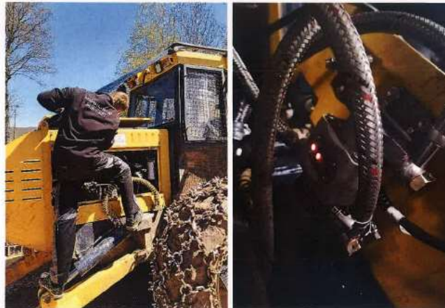
Slika 10a. Ugradnja protočnog mjerača – UŠP Gospić
