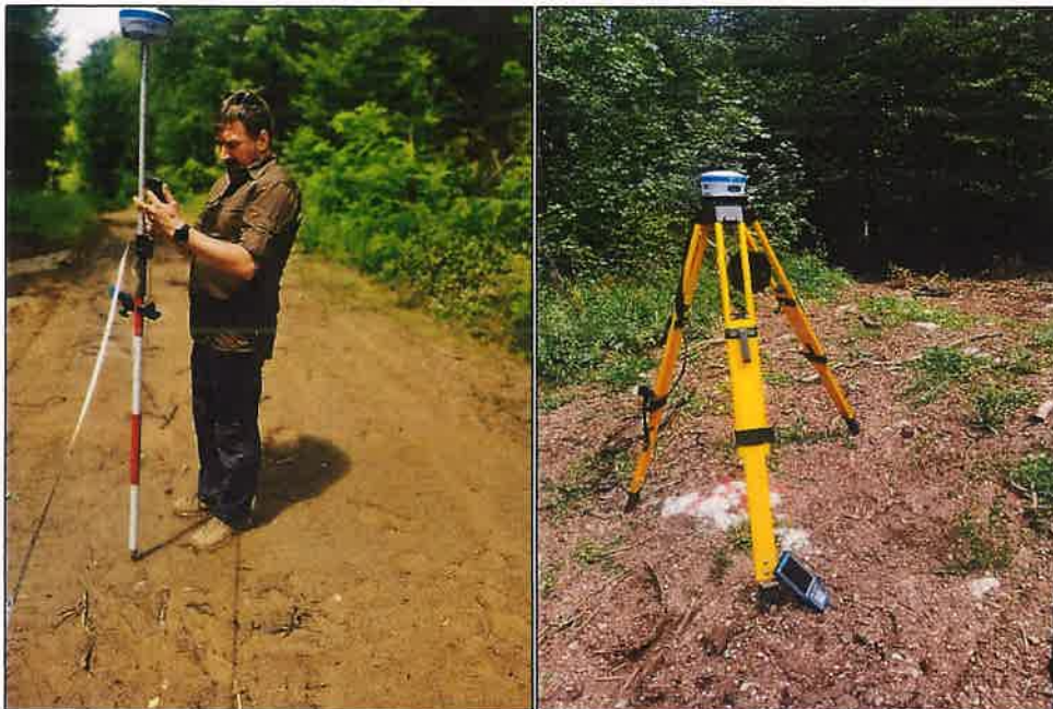
Slika 6. Izmjera komponentom 1 pomoću sustava CROPOS i sustav baza-rover
