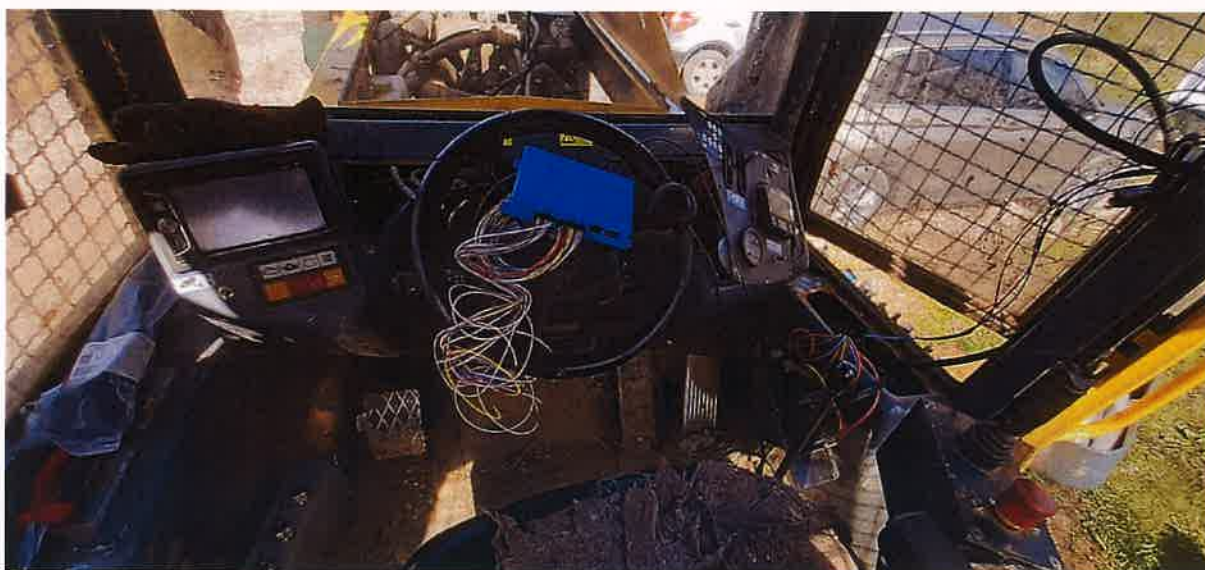
Slika 8. Spajanje WIGO-E mobilne jedinice sa senzorima motora - Perušić
