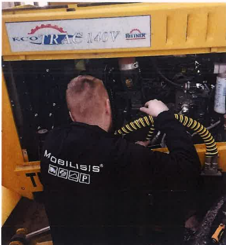
Slika 14a. Ugradnja protočnog mjeraca goriva - Garešnica
